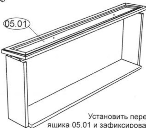
Установить переднюю стенку ящика 05.01 и зафиксировать при помощи эксцентриковой стяжки. Установить ручки. При необходимости подкласть шайбы. На заднюю стенку ящика с внутренней стороны установить 3 самоклеящихся амортизирующих элемента.
