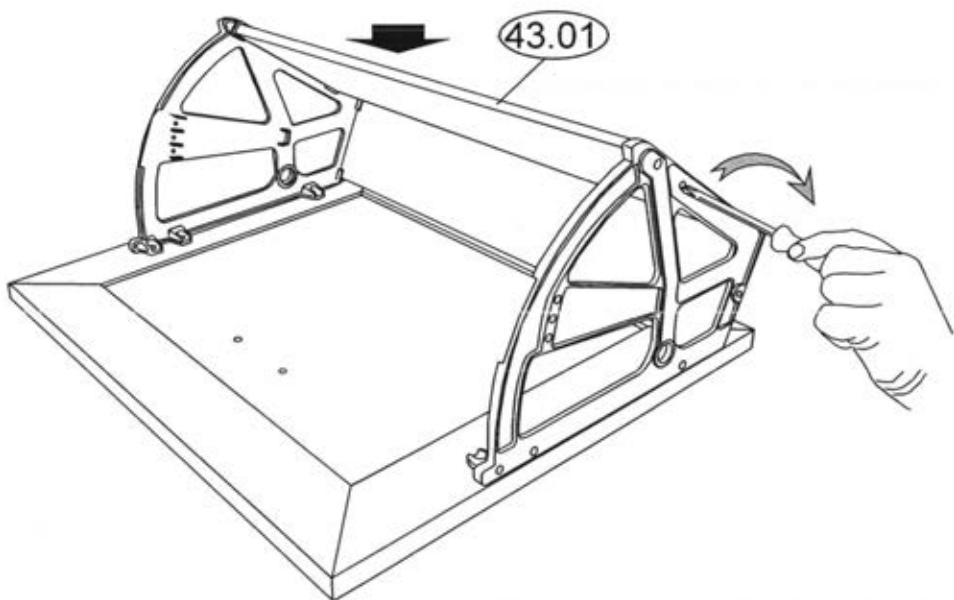
Установить полку 43.01 в пазы кронштейна задней части и зафиксировать шурупами 3x16 при помощи отвертки с 2-х сторон.
