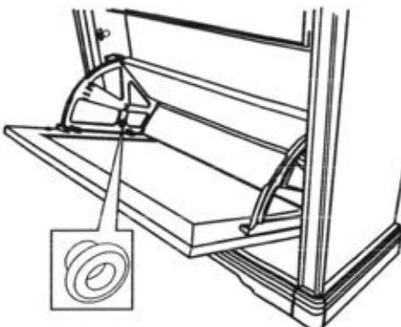
Установить ящик для обуви к вертикальным стенкам тумбы. Вставить пластмассовые втулки в отверстия кронштейна и зафиксировать винтом M6x20 при помощи отвертки.
