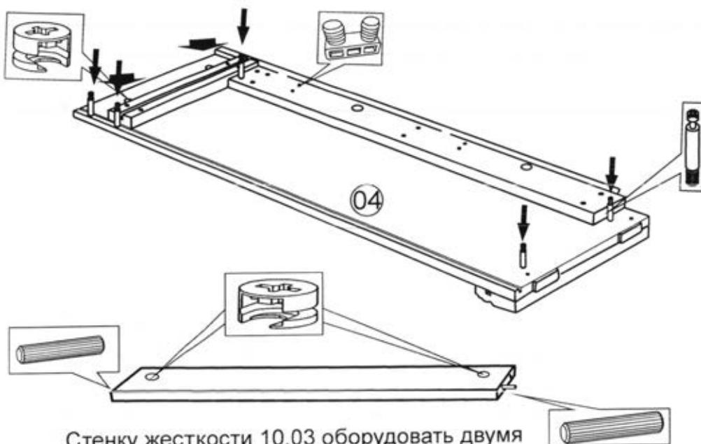
Стенку жесткости 10.03 оборудовать двумя эксцентриками на 16 и двумя шкантами.
