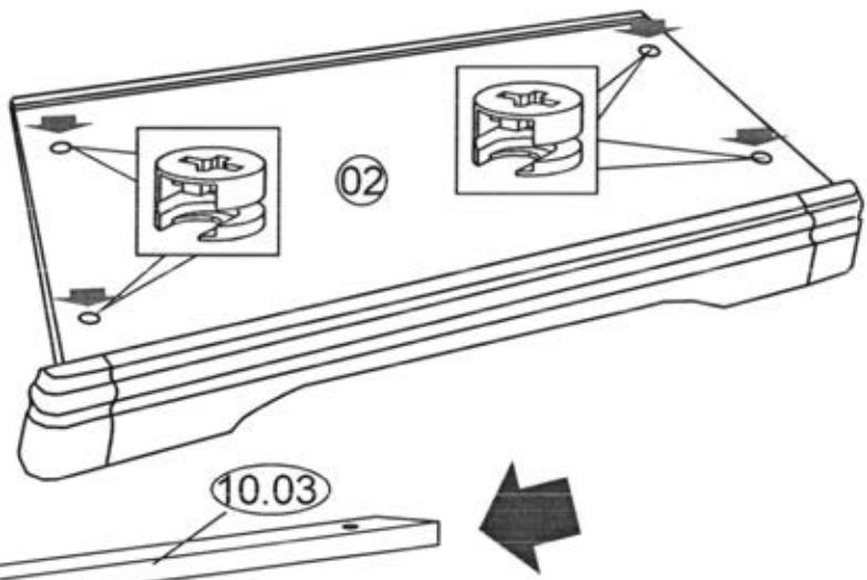
К стенке вертикальной 03 приставить стенку горизонтальную 02, совместив соединительные винты стенки 03 с отверстиями стенки 02. Крепить стенку вертикальную к стенке горизонтальной на эксцентриковую стяжку. На соединительный винт стенки 03 установить стенку жесткости 10.03 **таким образом, чтобы эксцентрики находились вверху** и закрепить на эксцентриковую стяжку. Во время монтажа придерживать стенку вертикальную во избежание ее падения.
