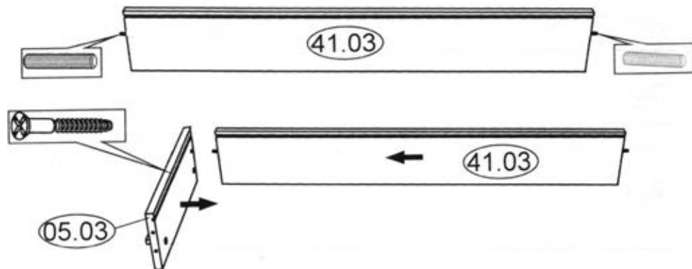
Установить боковые стенки ящика 05.02 и 05.03 к задней стенке 41.03 соединив их шкантами и зафиксировать евровинтами при помощи отвертки.
