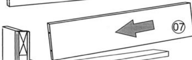
Приставить стенку жесткости 07 отверстиями к соединительным винтам стенки вертикальной 03 и зафиксировать на эксцентриковую стяжку.
