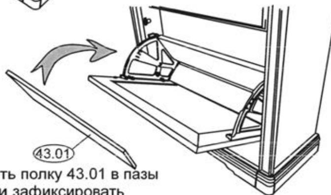
Установить полку 43.01 в пазы кронштейна и зафиксировать шурупами 3-3x16 с 2-х сторон.
