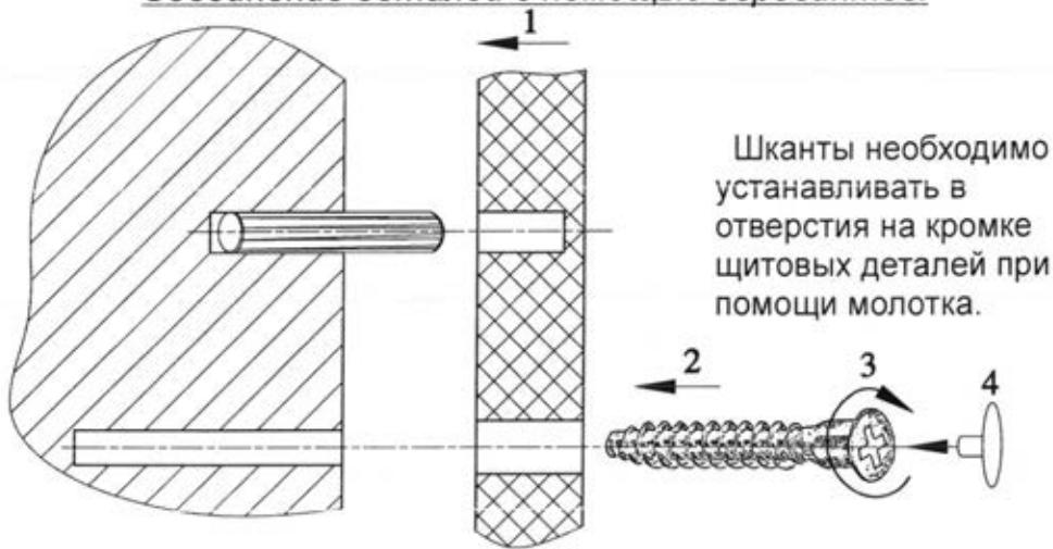
Стенку вертикальную 03 уложить на прокладочный материал. В отверстия на пласти стенки 03 установить 2 эксцентрика на 19, 5 соединительных винтов. При помощи молотка установить 2 упора. При помощи шурупов установить 2 магнитные защелки. В отверстия на нижней кромке установить 2 наконечника.
