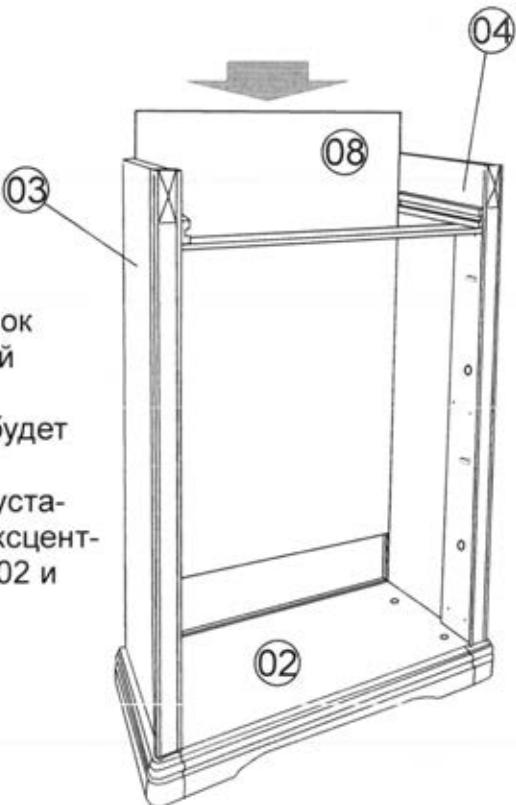
В пазы вертикальных стенок 03 и 04, а так же горизонтальной стенки 02 установить заднюю стенку 09. Если задняя стенка будет входить в пазы с затруднением, необходимо ослабить, а после установки задней стенки затянуть эксцентрики на стенке горизонтальной 02 и стенке жесткости 07.
