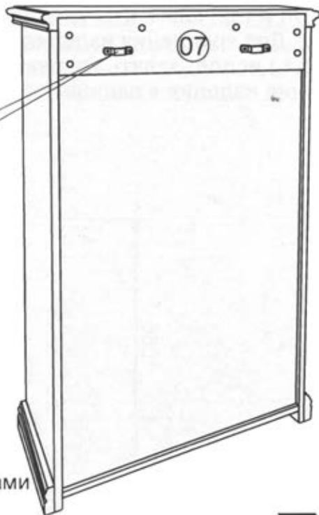
Установить подвесные планки на стенку жесткости 07, совместив отверстия в планке с отверстиями в стенке 07 и зафиксировать шурупами 4x16 с помощью отвертки..
