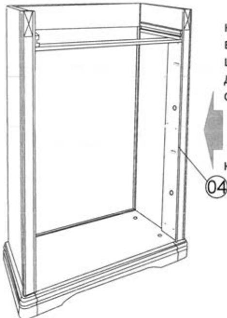
Приставить стенку вертикальную 04 соединительными винтами к собранной конструкции таким образом, чтобы соединительные винты вошли в отверстия сопрягаемых деталей.
