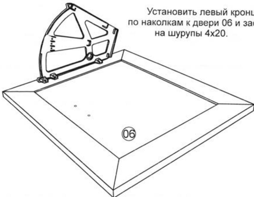
Установка кронштейнов тумбы выполняется в следующей последовательности:
